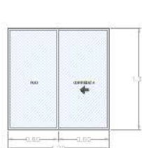
Ventana 1 CRISTAL CLARO DE 4mm CON MARCO DE ALUMINIO BLANCO VISTA EXTERIOR / ALZADO
